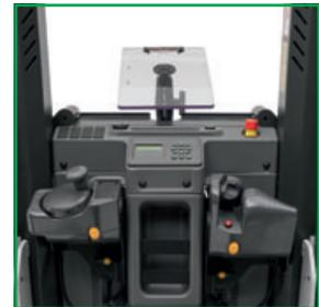
Die Pro Access Schutzbügel verhindern den Einsatz des Staplers bei geöffneten Schranken über 1200 mm Höhe durch integrierte Sensoren.
