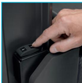
Der schnelle und einfache Zugang zur Batterie erleichtert die tägliche Wartung und den Batteriewechsel im Mehrschichtbetrieb.
