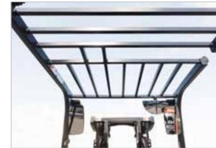
Die übersichtlich angeordneten Hydraulikschläuche und Ketten bieten eine gute Durchsicht nach vorn.
