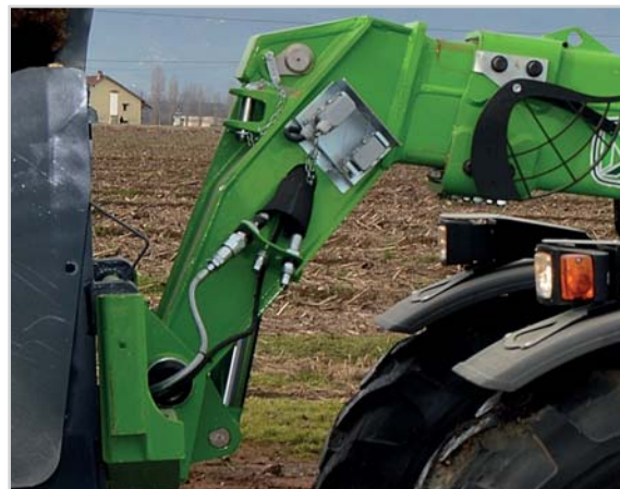
Rohre, Elektrokabel und zusätzliche Hydraulikleitungen befinden sich im Inneren des Teleskoparms
