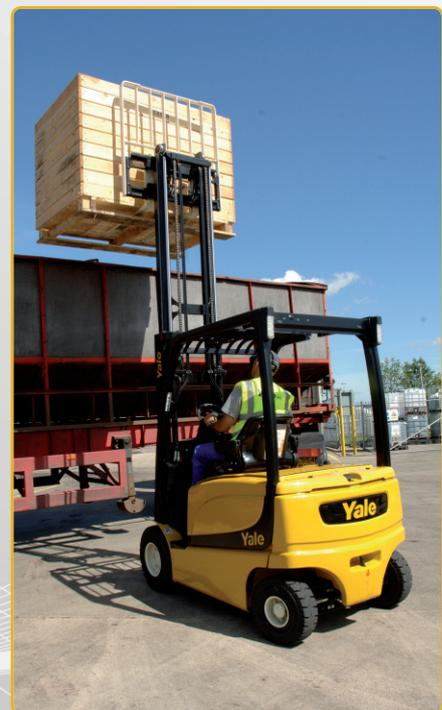
Die Maximalwerte für Geschwindigkeit und Beschleunigung des Modus 4 können vom Servicetechniker eingestellt werden, die drei anderen Modi werden automatisch prozentual angepasst.
