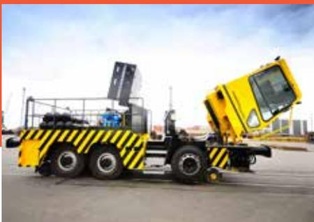
Leichter Zugang für Wartungsarbeiten
