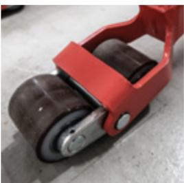
Tandemrollen vorne für mehr Stabilität und zur Vermeidung von Bremspuren
