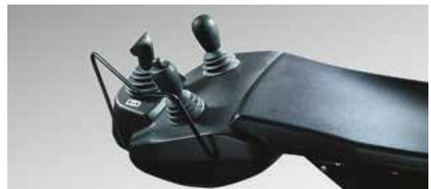
Fahrtrichtungswechsel per Hebel in der Armlehne oder an der Lenksäule (auch möglich mit D2-Fahrpedal)
