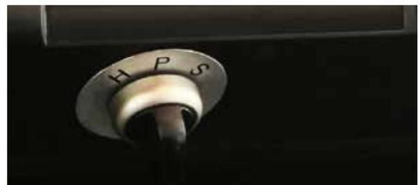
Wählschalter für Fahrmodus (H/P/S) zur einfachen Anpassung der Beschleunigung und der automatischen Bremswirkung an die Vorlieben des Fahrers
