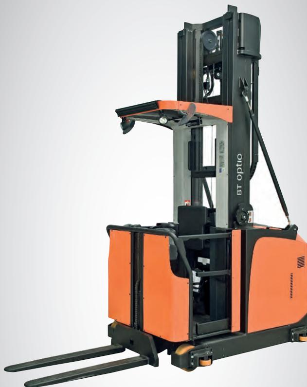
Konzipiert für Schmalgang-Einsätze in der Höhe mit Induktiv- oder Schienenführung. Außerhalb der Gänge ist auch der ungeführte Einsatz möglich.
