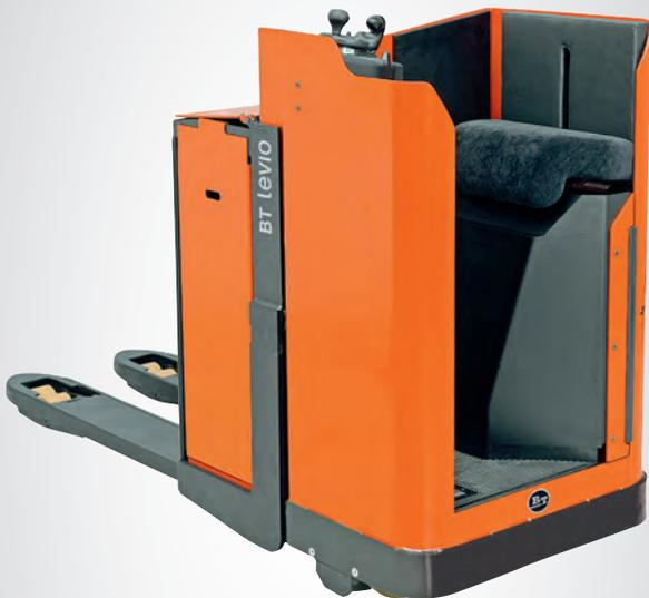
Voll verkleideter Fahrerstand mit Bedienerposition quer zur Fahrtrichtung für die Arbeit auf engem Raum
