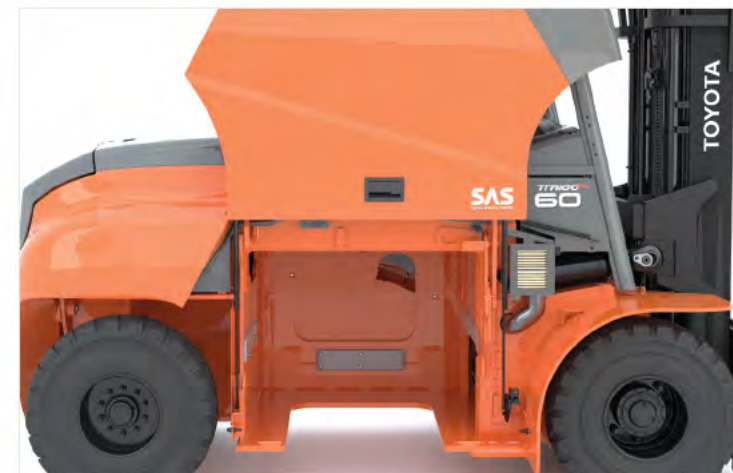
Einfach zu öffnende Batteriehaube für einen schnellen, seitlichen Batteriewechsel
