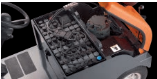
Dank ihrer 48-V-Elektrik mit AC-Motoren verbinden die Elektroschlepper der Toyota Tracto R-Serie kraftvolle Beschleunigung mit hoher Energieeffizienz und einfachem Service
