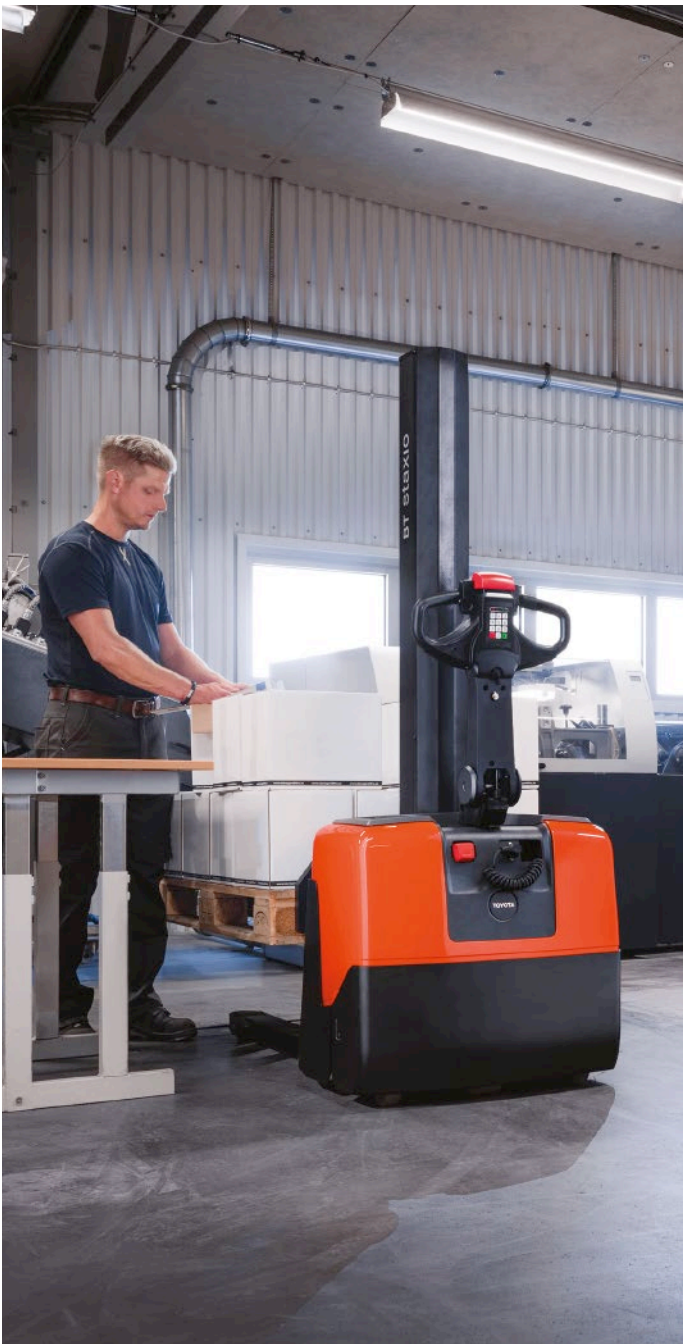
Modell HWE100S mit verstellbaren Stützarmen zur Beförderung von Ladungsträgern unterschiedlicher Größe
