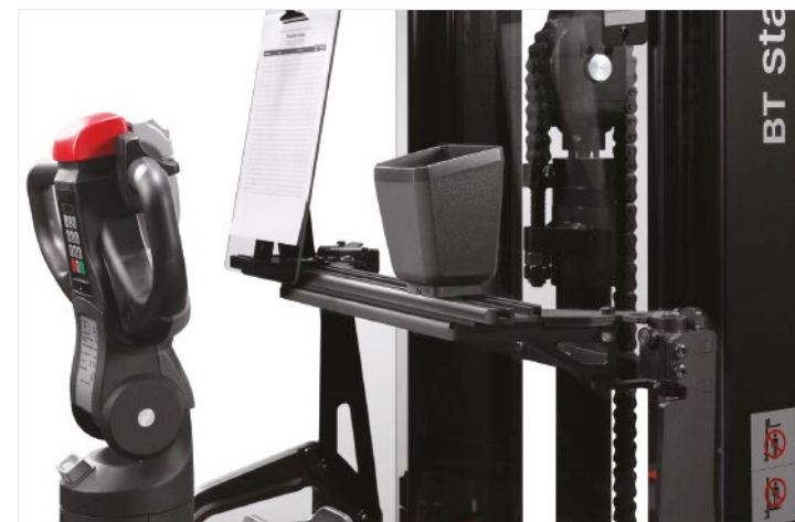
E-Bar für das einfache Anbringen von Zusatzausrüstung
