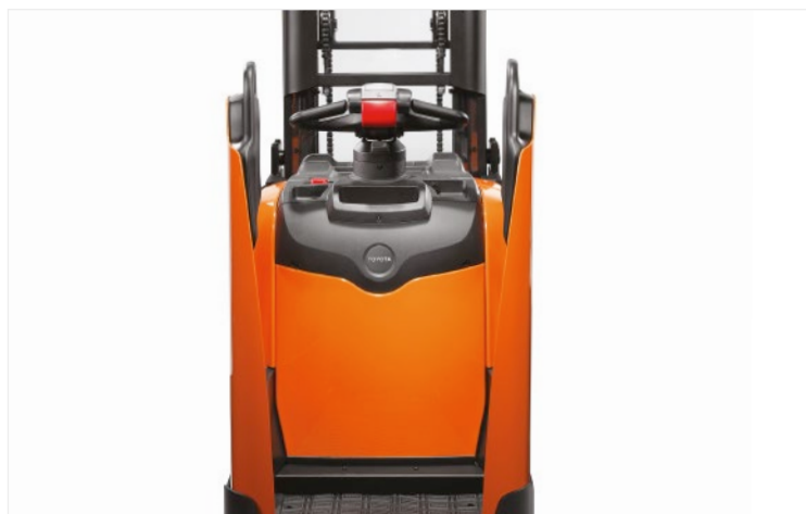
Seitenschutz und E-man Lenksystem für sichere und komfortable Einsätze auf langen Distanzen
