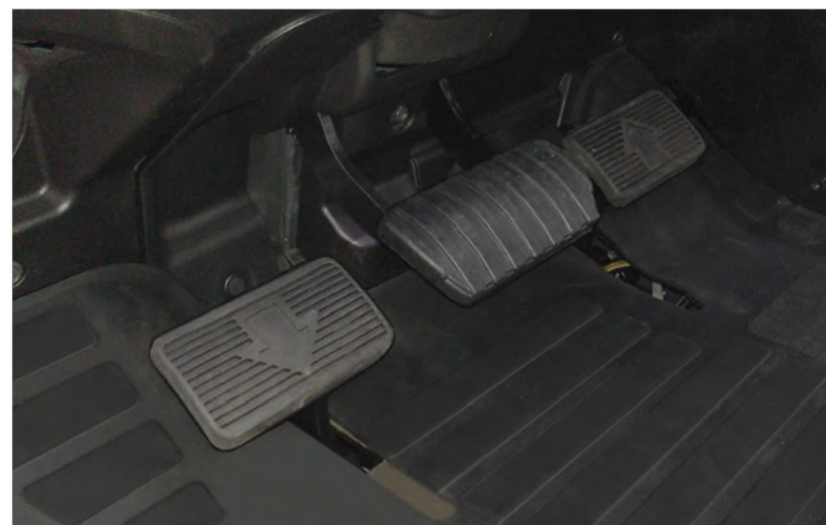
Auswahl unterschiedlicher Pedalanordnungen passend zum Einsatz (abgebildet: Doppelpedal)
