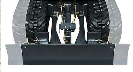
Durch die einfache Demontage von jeweils einem Verriegelungsbolzen, werden die nach innen einklappbaren Seitenteile des Planierschild, entsprechend der Fahrwerksbreite angepasst.
