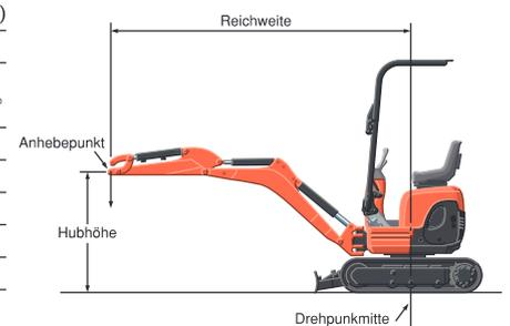
\* Die technischen Daten über den Arbeitsbereich der Maschine wurden mit dem Kubota Standard - Tieflöffel ermittelt, ohne Schnellwechseinrichtung.
