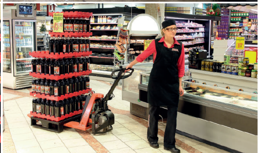
Zum Lastentransport mit minimalem Kraftaufwand ist der BT Pro Lifter (LHT100) mit einem Elektromotor am Hauptrad ausgestattet. Mit nur einem Tastendruck kann eine Last von bis zu einer Tonne bewegt werden.
