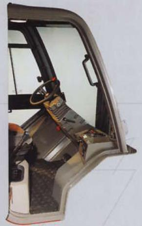
Mit dem Kreuzhebel rechts vom Sitz werden die Hub-, Senk und Neigungsfunktionen (10°/12°) bedient. Der MSI verfügt über eine geschwindigkeitstunabhängige **Drehzulanhebung für schnelle Hubbewegungen.**
