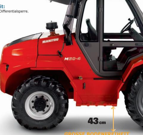
Pendelachse hinten mit hoher **Bodenfreiheit**
