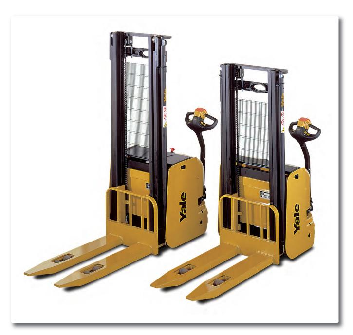
ist jederzeit möglich. Die Steuerung umfasst automatisches Bremsen (Gegenstrombremsen), regeneratives Bremsen beim Loslassen der Flügelschalter sowie Rückrollschutz und Anfahrhilfe an Steigungen.
