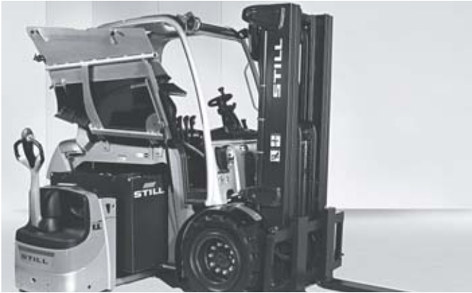
Einfacher seitlicher Batteriewechsel mit Niederhubwagen und Batteriewechselgestell
