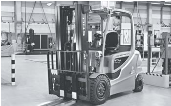
Ex-Schutz-Version mit gekapselten elektrischen Komponenten
