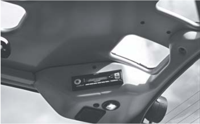
Sichtfenster auch nach hinten-oben, um Rolltorschäden zu vermeiden
