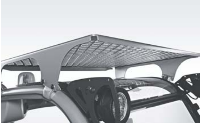
Stabiler Zusatzschutz gegen fallende Lastteile
