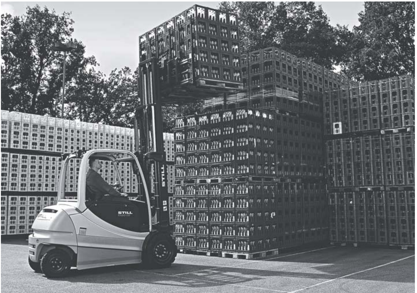
Ex-Schutz-Version mit gekapselten elektrischen Komponenten
