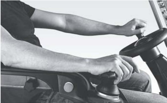
Entspanntes Arbeiten mit Anbaugeräten dank Joystick 4Plus mit Armlehne
