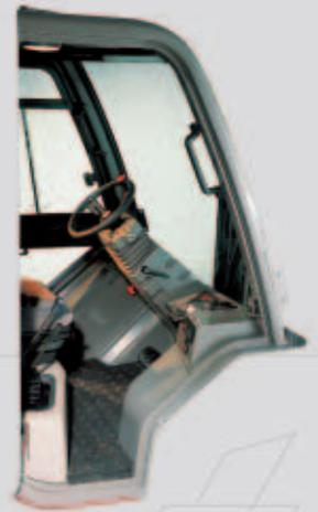
Mit dem Kreuzhebel rechts vom Sitz werden die Hub-, Senk und Neigungsfunktionen (10°/12°) bedient. Der MSI verfügt über eine geschwindigkeitstunabhängige **Drehzahlanhebung für schnelle Hubbewegungen.**
