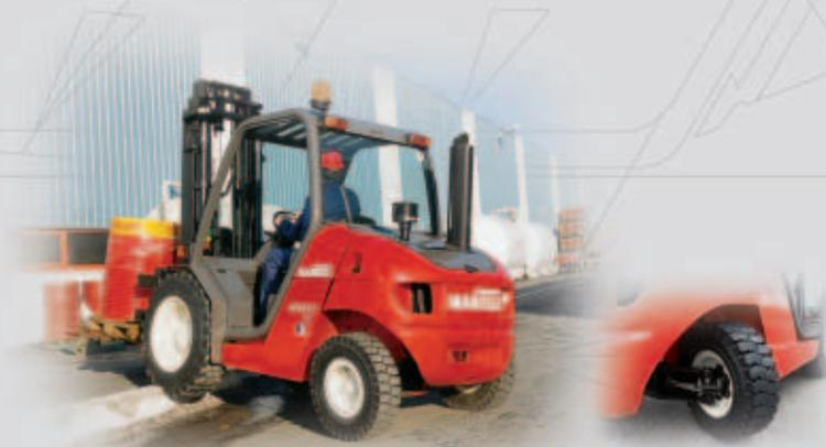
Optimale Sicherheit und Wendigkeit garantiert der MSI unter anderem durch seine extreme Stabilität im beladenen Zustand und **den sehr kleinen Lenkradius**, der mit Hilfe der neuen Lenkachse mit integriertem Zylinder erzielt wird.
