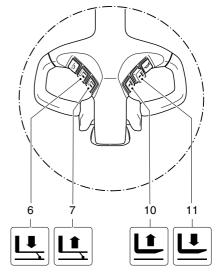
M Zur Transportfahrt muß die Lastgabel auf die angehobenen Radarme abgesenkt werden
