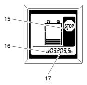
**Batterieentladewächter:** Beim ständigen Aufleuchten des "STOP"-Symbols wird die Funktion Heben abgeschaltet.
