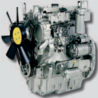
Der Perkins Motor 1104 C 44 - 4 Zylinder mit Direkteinspritzung, wurde wegen seiner Leistungskraft und seiner Zuverlässigkeit gewählt. Er entwickelt eine Leistung von 84 PS/61,5 kW bei einer Nenndrehzahl von 2200 U/min und entspricht der Euronorm 2. Je nach Art der auszuführenden Arbeit und für die Wahl des Beweglichkeitsgrades bzw. der Fahrgeschwindigkeit, ist der MC 30 mit einem Viergangwandlergetriebe ausgestattet.
