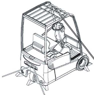
Verzurren und Verkeilen ohne Hubgerüst
