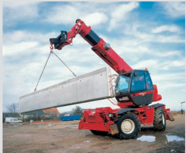
...handhaben von umfangreichen Lasten mit dem Kranausleger mit Haken PC 50...
