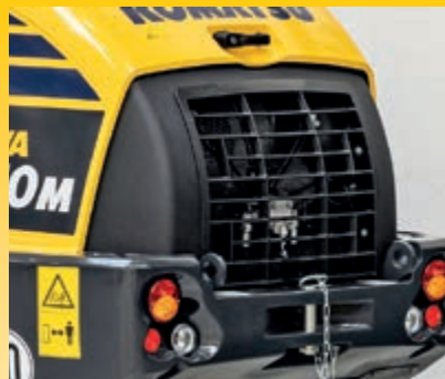
Grobmaschiger Kühler mit automatischem Umkehrlüfter (optional)
