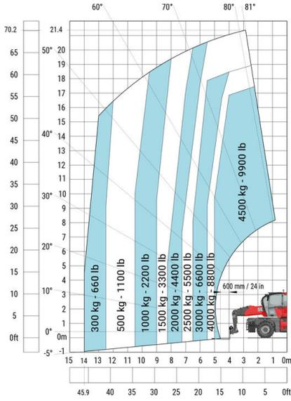
Drehung mit abgesenkten Stützen mit Gabeln
