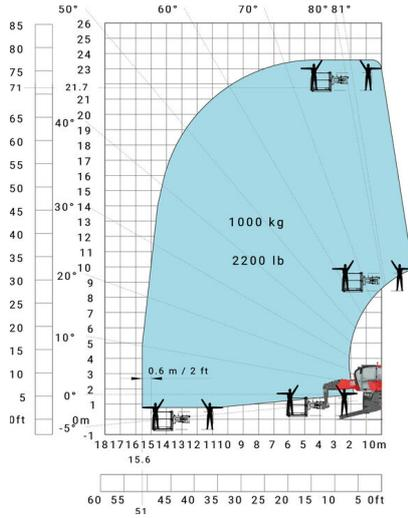
Drehung mit abgesenkten Stützen mit 3D positiv
