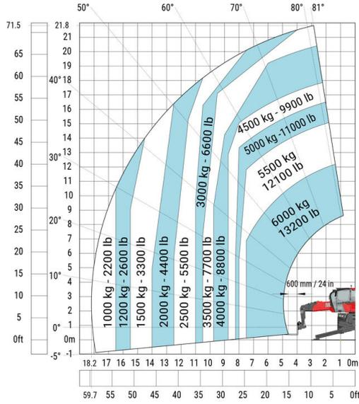
Drehung an abgesenkten Stützen mit 1500 kg Ausleger
