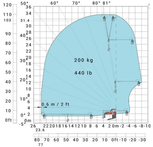
Drehung an abgesenkten Stützen mit 3D negativ
