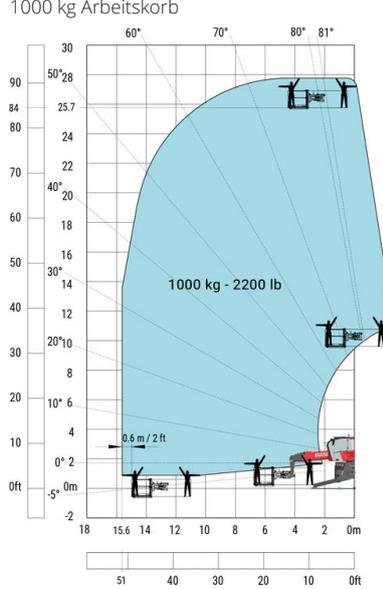
Drehung mit abgesenkten Stützen mit 3D positiv
