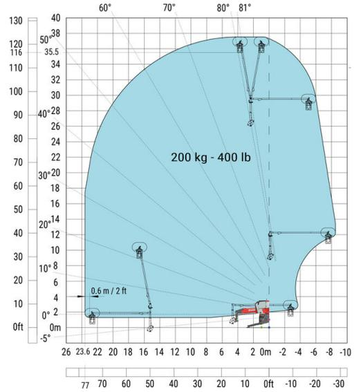
Drehung mit abgesenkten Stützen mit 3D negativ
