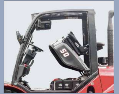
Der leicht zu öffnende Haken ermöglicht einen schnellen Zugang zum Motorraum
