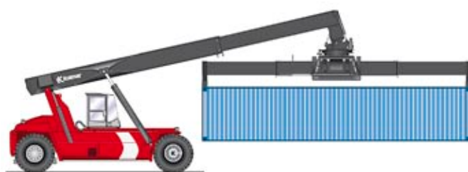
Container können in Längsrichtung aufgenommen und transportiert werden. Dies erlaubt das Passieren von Hallentoren, usw.
