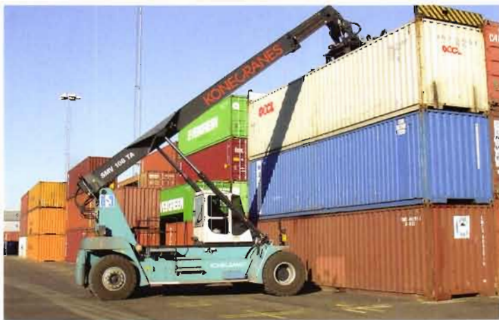
Praktisch, kompakt und leicht zu steuern. Kleinere Reach Stacker können Leercontainer auch bei begrenztem Platzangebot präzise bewegen und auf eine Höhe von bis zu 6 Containern anheben.
