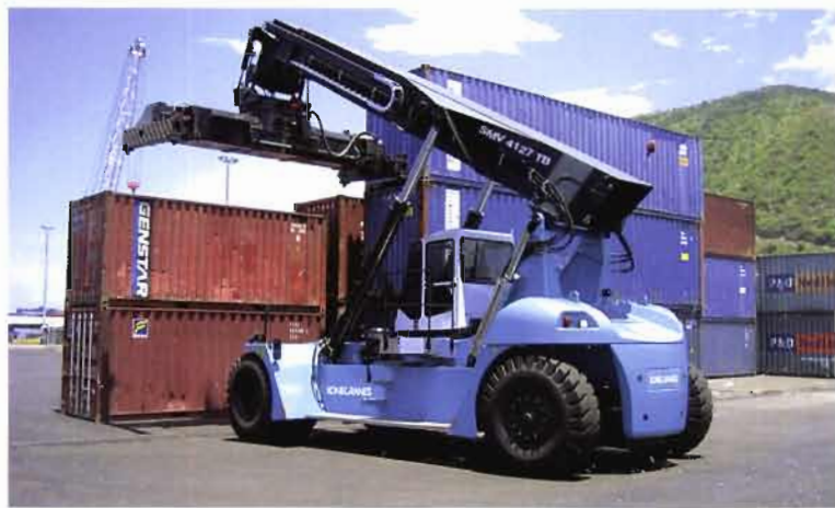
Ein ideales Arbeitsgerät für Standorte mit hohem Umschlagtempo. Die Anbauelemente machen auch unsere großen Fahrzeuge zu flexiblen Maschinen. Hebt 41 bis 45 Tonnen in eine Höhe von 5 oder 6 Containern.
