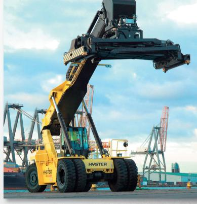
4 Hubösen an den 4 Twistlocks des Teleskop-Container-Spreaders zum Heben von Stückgut (min. 6 m Länge). HINWEIS: Volle Tragfähigkeit (40 Tonnen) ist nur an den Endpositionen 20' (6 m) oder 40' (12 m) des Spreaders, nicht bei einer Zwischenposition möglich.
