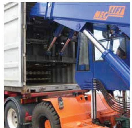
*"Wir verwenden zwei Meclift ML1812R Maschinen zum Be- und Entladen von Stahlspulen in und aus Containern in unserem Hafen. Diese Maschinen sind einzigartig im Design. Durch ihre geringe Bauhöhe und ihre gute Reichfähigkeit können wir sie auch in anderen Bereichen einsetzen. Manchmal fragen wir uns, wie einige dieser Arbeiten ohne Meclift-Trucks getan werden können."*
