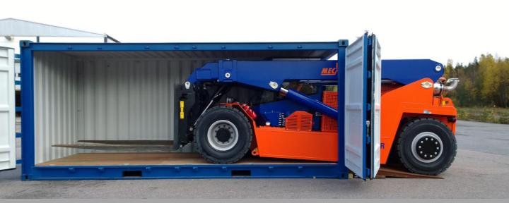
Der ML1812R kann aufgrund seiner geringen Bauhöhe direkt in einen Container fahren.
