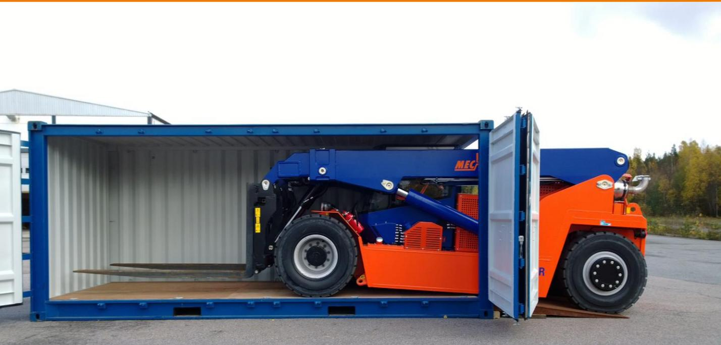
Der ML1812R kann aufgrund seiner geringen Bauhöhe direkt in einen Container fahren.
