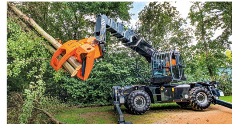
Automatische Kettenspannung, endlos drehbar.
