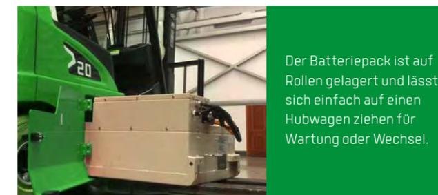
Der Batteriepack ist auf Rollen gelagert und lässt sich einfach auf einen Hubwagen ziehen für Wartung oder Wechsel.
