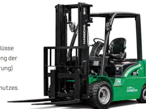
Das ergonomisch gestaltete Lenkrad mit kleinem Durchmesser kann in der Neigung eingestellt werden und liegt jederzeit bequem in der Hand. Der Fahrersitz lässt sich 210 mm nach vorne- und zurückschieben, so dass jeder Fahrer seine optimale Fahrposition selbst einstellen kann.
