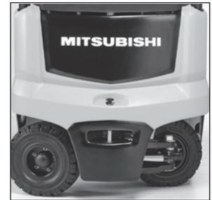
Hinterachse um 100 Grad lenkbar
