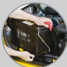
Schwenkbar installierte Batterie
