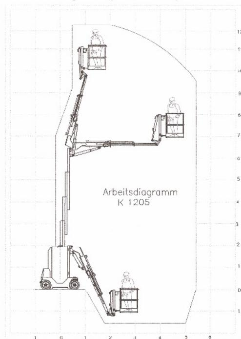
Es handelt sich hier um eine elektrisch betriebene, kompakte, selbstfahrende Teleskopmast-Arbeitsbühne mit Korbarm (Arbeitshöhe bis 12 m), welche speziell für Wartungs- und Instandhaltungsarbeiten in beengten Bereichen entwickelt wurde.
