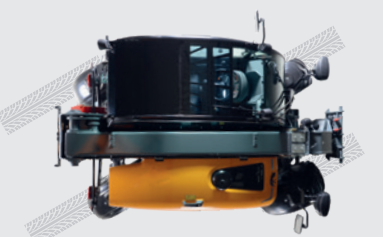
Hundegang Ermöglicht das Fahren und Arbeiten nah an Wänden.
