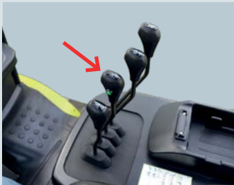
Aktivierungsschalter am mechanischen Hydraulikhebel
