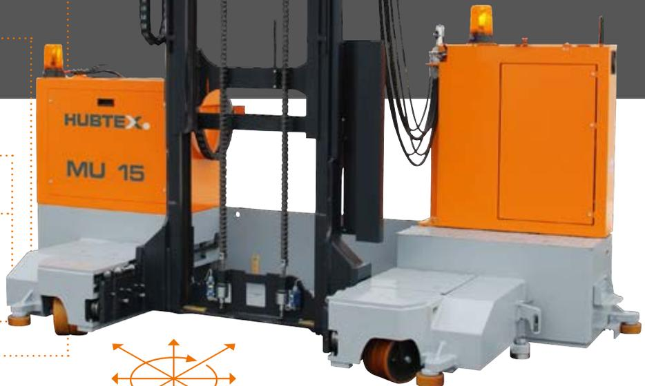
Abbildung zeigt nicht standardmäßige Zusatzausstattung, insbesondere reduzierte Gerätebreite durch Wegfall der Batterie hinter dem Mast.
