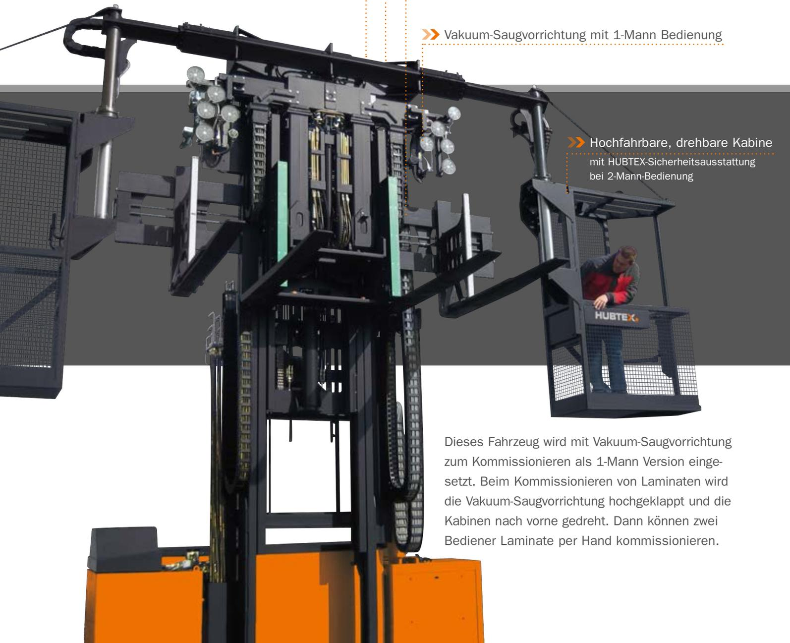
Dieses Fahrzeug wird mit Vakuum-Saugvorrichtung zum Kommissionieren als 1-Mann Version eingesetzt. Beim Kommissionieren von Laminaten wird die Vakuum-Saugvorrichtung hochgeklappt und die Kabinen nach vorne gedreht. Dann können zwei Bediener Lamine per Hand kommissionieren.
