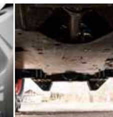
Stahlplatte zum Bodenschutz
