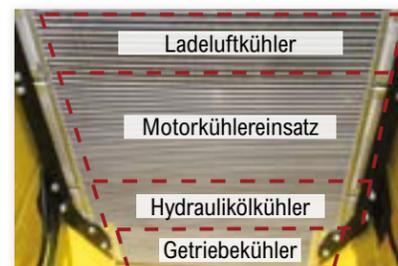
Quad-Core-Konfiguration ermöglicht eine effiziente Kühlung
