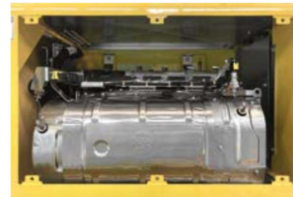
Zugang zur Abgasnachbehandlungseinheit mit Lüftungsöffnung (oben) und ohne Lüftungsöffnung (unten)
