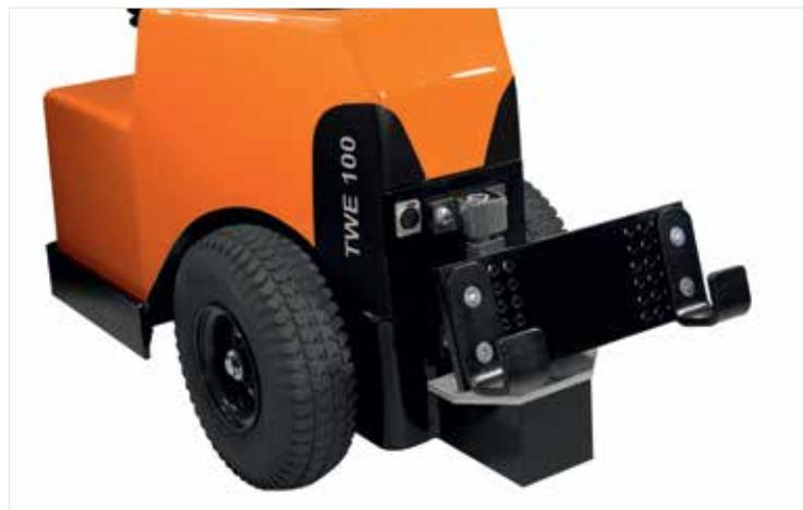
Lastenträger lassen sich dank der großen Auswahl an Verbindungen und Kupplungen problemlos anhängen.
