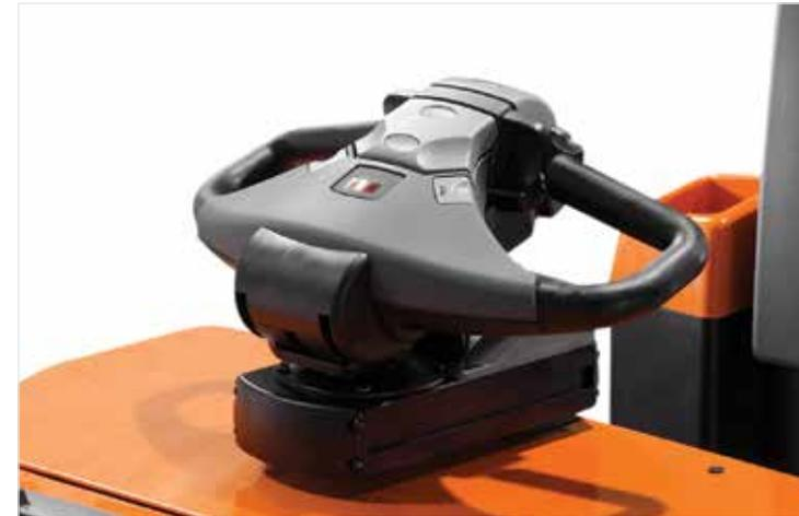
E-man-Lenksystem mit beweglichem Lenkarm für den rechts- oder linksgeführten Mitgängerbetrieb
