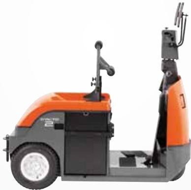
Kompakter Schlepper mit Fahrerstand für den Horizontaltransport, besonders geeignet für kurze Strecken und häufiges Auf- und Absteigen.
