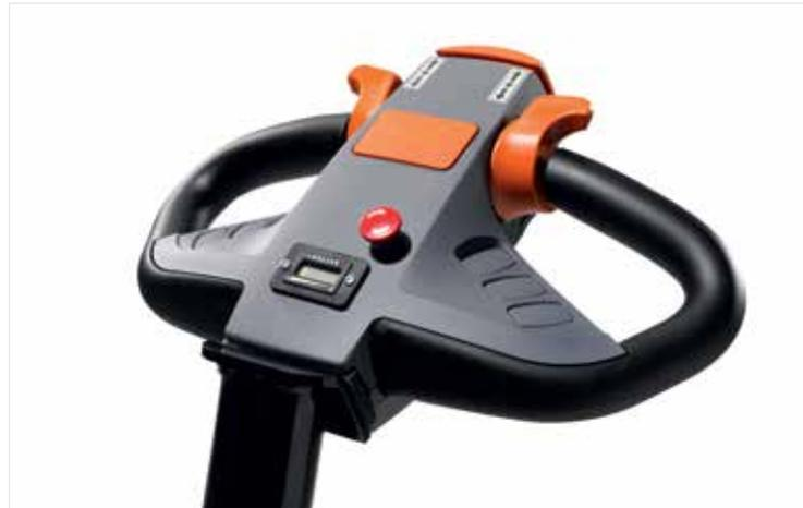
Die bequem und einfach zu führende Deichsel verfügt über eine deutliche, übersichtliche Batterieladestandsanzeige.
