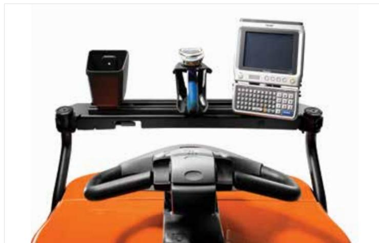
E-bar mit Stromversorgung zum einfachen Anbringen von wichtigen Peripheriegeräten
