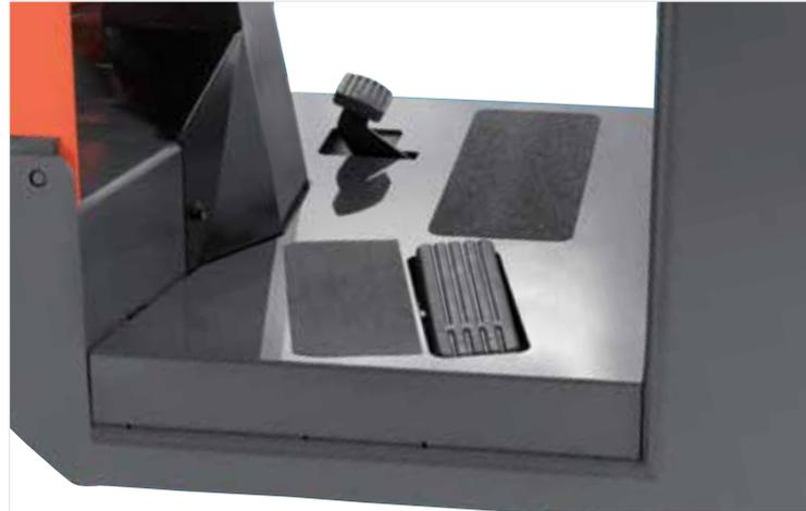
Die niedrige Einstiegshöhe der S-Serie erleichtert das Ein- und Aussteigen. Das OPS-System (Optimaler Personen-Schutz, linkes Pedal) sorgt dafür, dass das Gerät nur dann bedient werden kann, wenn der Fahrer in Fahrposition steht.
