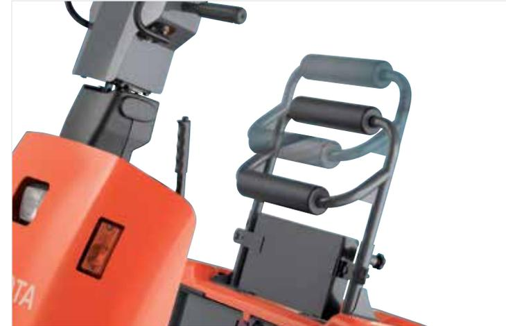
Die höhenverstellbare Rückenlehne bietet unterschiedlich großen Bedienern komfortablen Halt. Die höhenverstellbare Rückenlehne bietet unterschiedlich großen Bedienern komfortablen Halt.
