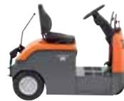
Die kompakten 4CBT-Modelle mit nur 800 mm breitem Chassis sind mit jeweils 2, 3 oder 4 Tonnen maximaler Anhängelast erhältlich.
