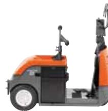
Die kompakten 4CBTY-Modelle sind mit Anhängelasten von 2 und 4 Tonnen erhältlich – und mit nur 800 mm Breite ideal für den Einsatz in beengten Platzverhältnissen geeignet.
