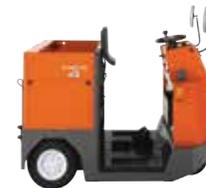
Die Schwerlastmodelle CBTY sind mit Anhängelasten von 4 und 6 Tonnen erhältlich und besonders geeignet für den Einsatz an Rampen und Steigungen.
