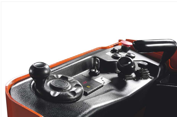
Einfache Steuerung durch kleines elektronisches Lenkrad
