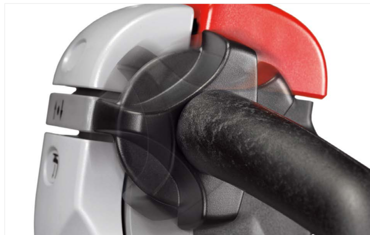
Fahren, Heben und Senken mit einem einzigen Fingertipp mit der einzigartigen Rangierfunktion „Click-2-Creep“
