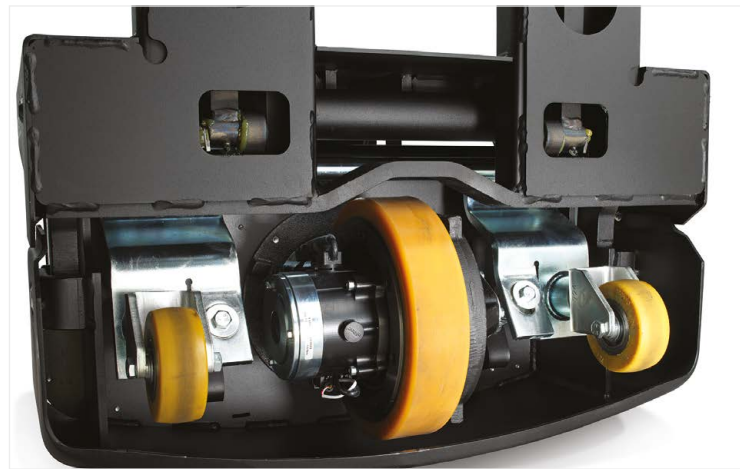
Das einzigartige Castorlink-System schützt die Stützrollen auf unebenem Untergrund
