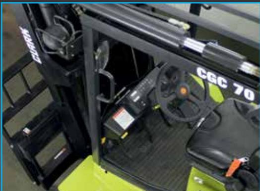
Der Innenraum des großzügig ausgelegten Fahrerarbeitsplatzes bietet dem Fahrer ausreichend Kopf- und Beinfreiheit. Über eine große Trittstufe kann der Fahrer bequem auf und absteigen. Haltegriffe auf beiden Seiten des Fahrzeugs erhöhen die Sicherheit. Die Lenksäule ist neigbar und kann individuell eingestellt werden.
