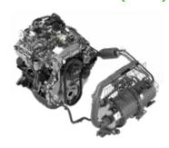
Dieser 3-Zylinder-Industrie-Dieselmotor ist im M300 mit Dieselmotor (2,0 bis 3,5 Tonnen) verbaut. Er verfügt über einen Kettenantrieb und ermöglicht dank des Turboladers mit variabler Geometrie selbst bei niedriger Motorendrehzahl einer sehr hohe Drehzahl.
