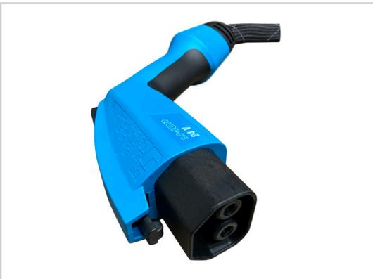
"Narrensichere" Steckverbindung für externes Ladegerät
